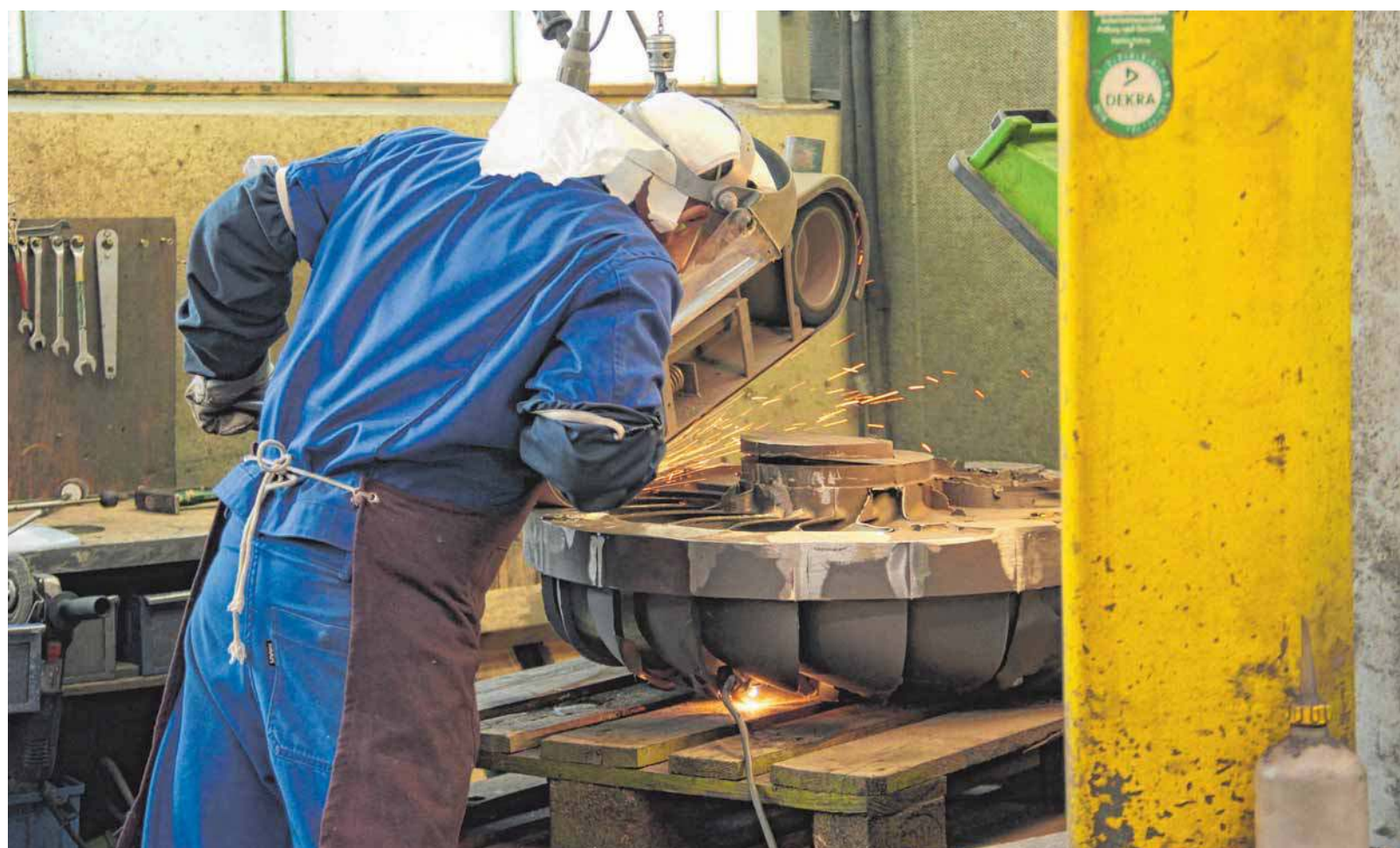
In den Hallen des Mengener Unternehmens Aluspan werden unter anderem Laufräder für Wasserkraftwerke bearbeitet.
